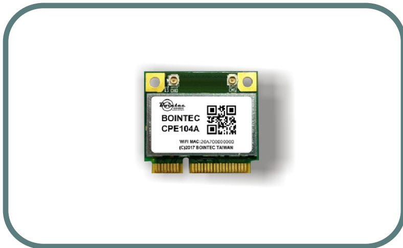
802.11ac/abgn/AC miniPCIe, 2T2R
